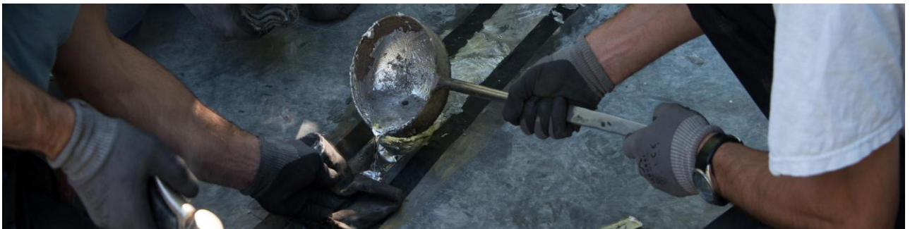
Le coulage du plomb pour fabriquer les canalisations
